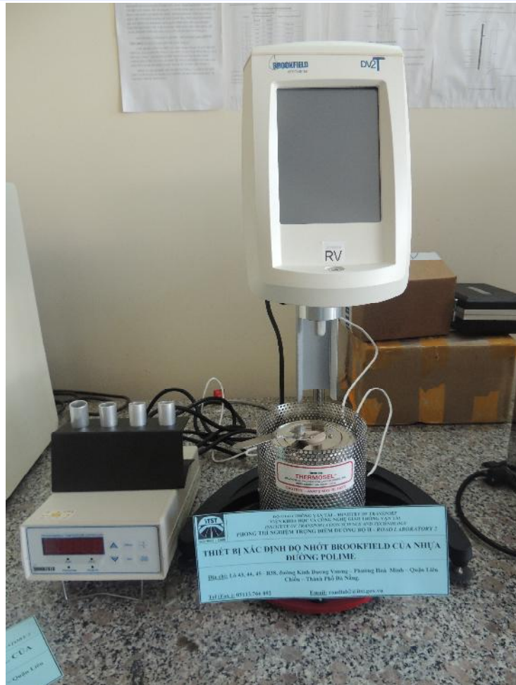
Thiết bị xác định độ nhớt Brook Field của nhựa đường Polime
