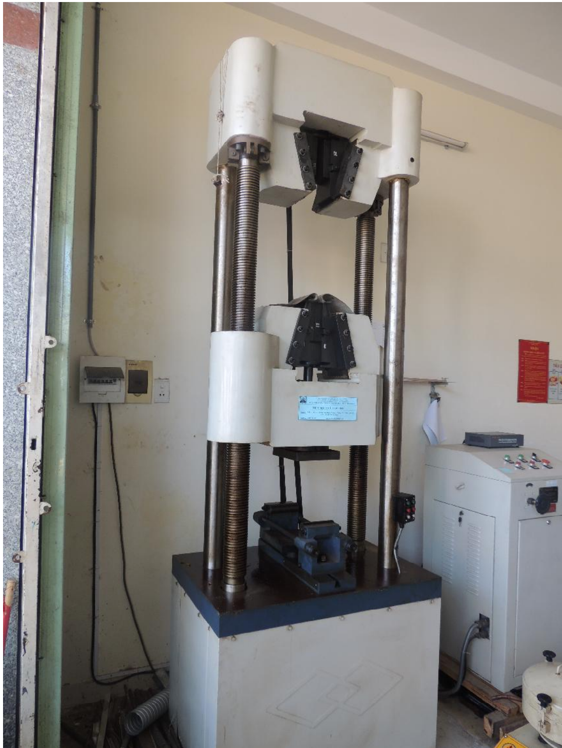
Máy kéo thép, cấp GEW - 1000B
