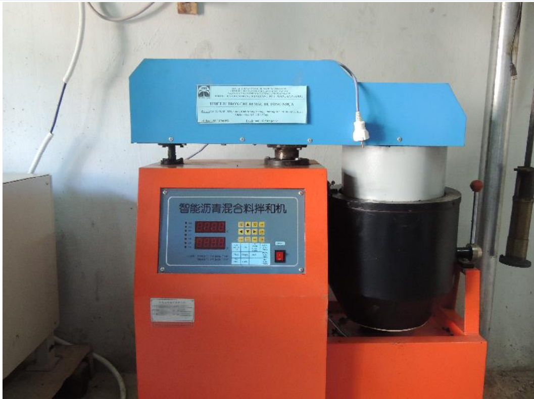
Thiết bị trộn chế bị mẫu Bê tông nhựa
