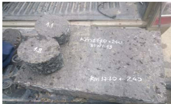
Mẫu BTN khoan cắt hiện trường
