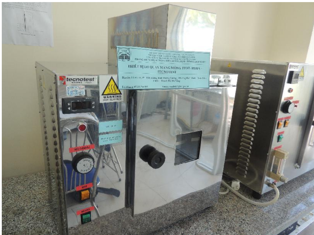
Thiết bị lò quay màng mỏng TFOT
