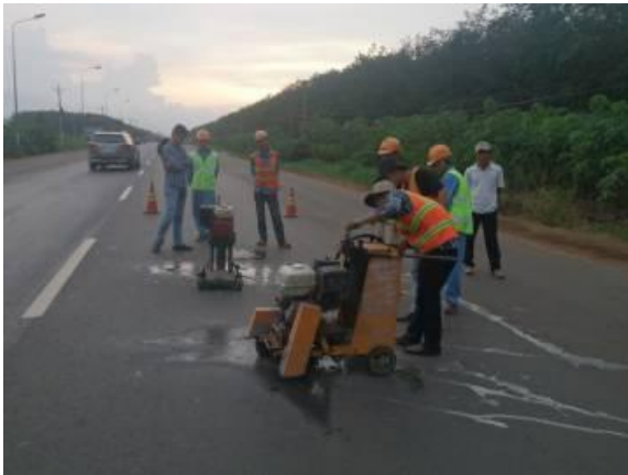
Công tác khoan cắt và lấy mẫu BTNC19 hiện trường
