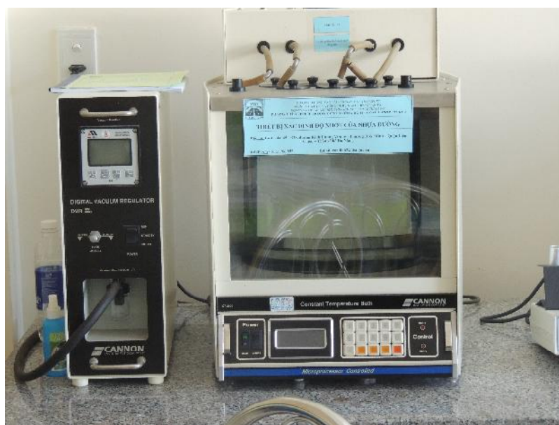
Thiết bị xác định độ nhớt của nhựa đường đặc, nhựa lỏng
