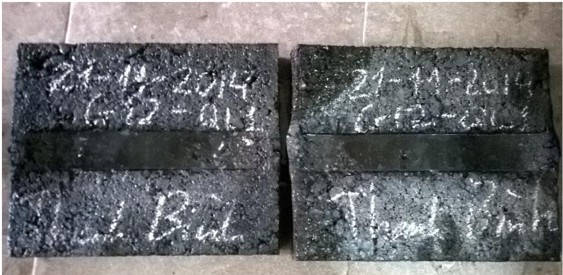
Mẫu Bê tông nhựa sau khi chạy hần lún
