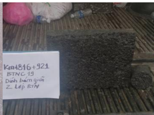
Kiểm tra độ dính bám của BTNC19 với các lớp bên dưới
