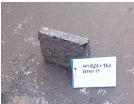
Kiểm tra độ dính bám của BTNC19 với các lớp bên dưới
