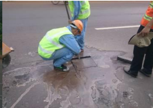
Công tác khoan cắt và lấy mẫu BTNC19 hiện trường
