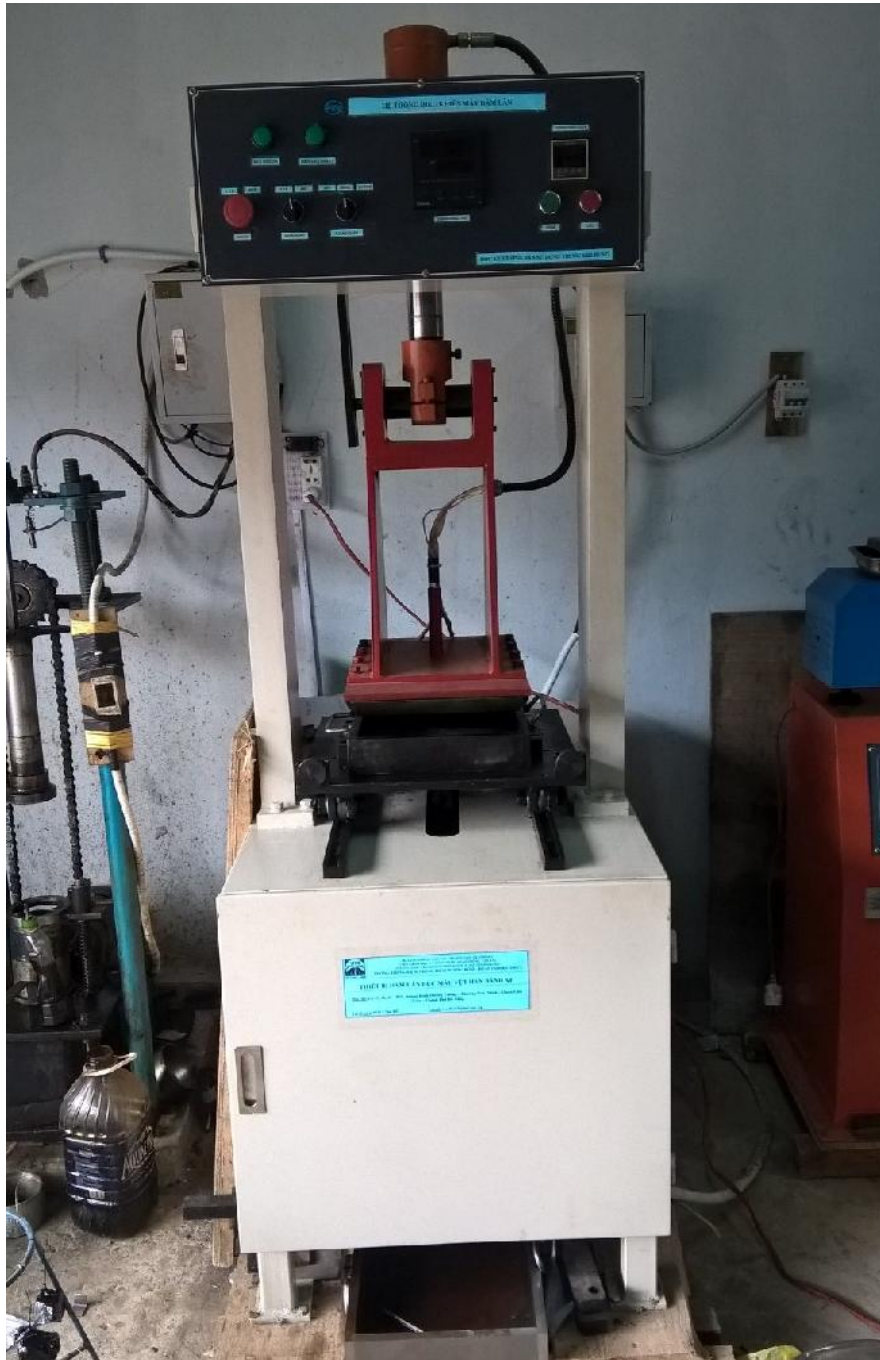
Thiết bị đầm lăn đúc mẫu vật hàn bánh xe
