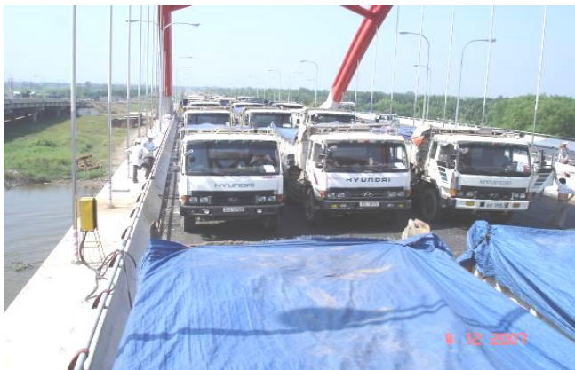
Kiểm định, thử tải Cầu Ông Lớn
