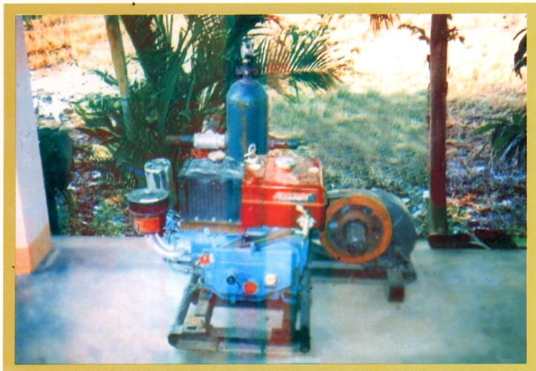
Máy khoan địa chất và khoan bê tông thân, mũi cọc khoan nhồi
