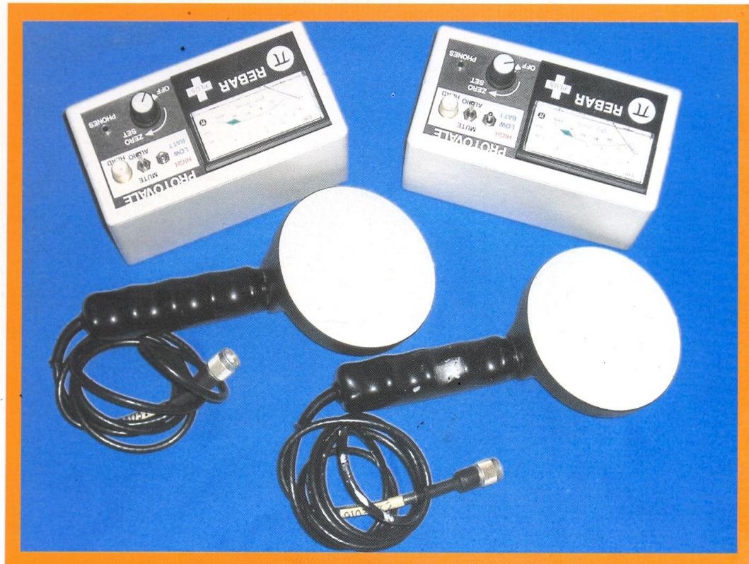
Máy xác định chiều dày lớp bê tông bảo vệ, vị trí và đường kính cốt thép trong bê tông
