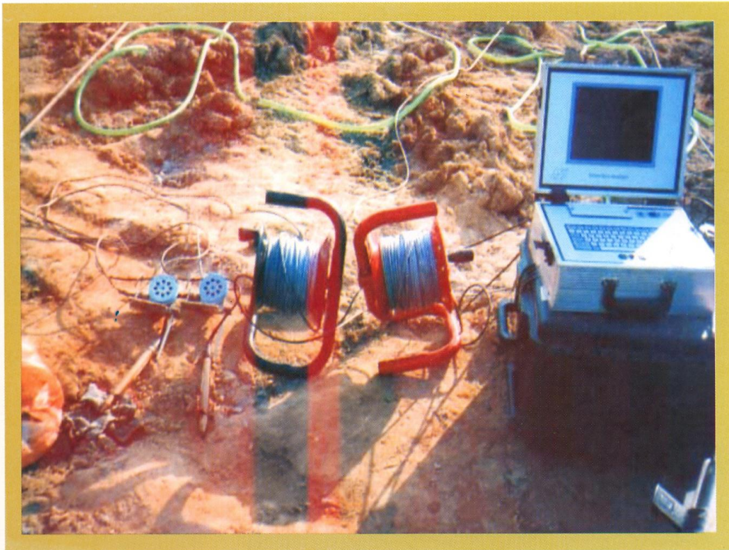
Máy siêu âm kiểm tra chất lượng bê tông cọc khoan nhồi (CHA)
