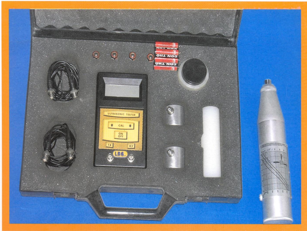
Máy siêu âm đánh giá chất lượng bê tông - Súng bật nẩy xác định cường độ bê tông
