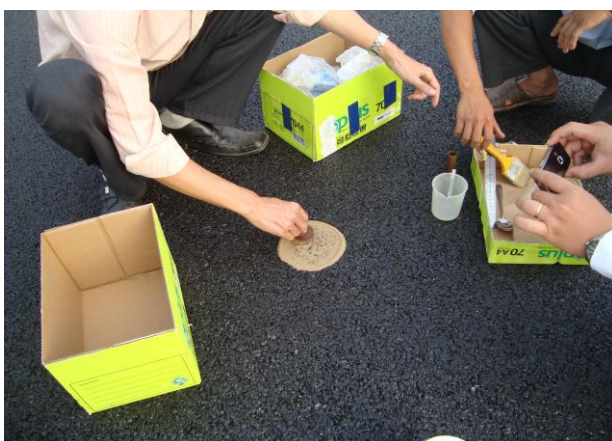
Công trình cầu Thủ Thiêm Đo độ nhám bằng phương pháp rắc cát
