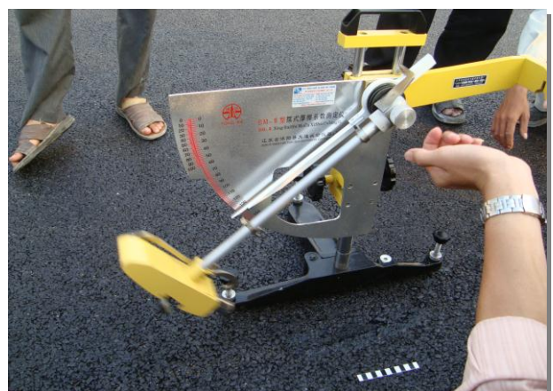
Công trình cầu Thủ Thiêm Đo độ nhám bằng con lắc Anh
