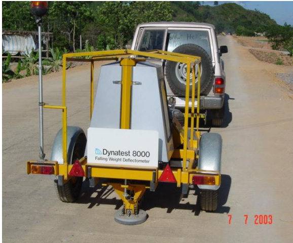
Hình 1. Đánh giá khả năng truyền tải của khe nối/vết nứt mặt đường BTXM cốt thép liên tục (CRCP) bằng thiết bị FWD, QL12-Quảng Bình
