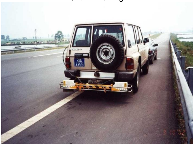
Hình 3. Xác định độ bằng phẳng mặt đường IRI bằng thiết bị Two Laser trên QL1 đoạn Hà Nội - Bắc Ninh
