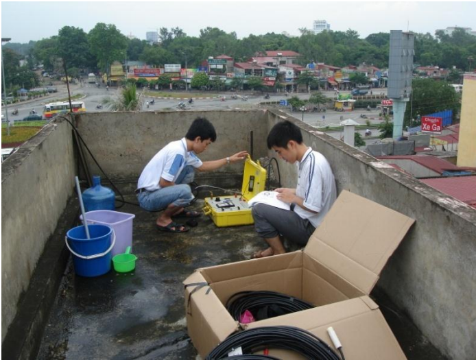
Hình 11: Thí nghiệm quan trắc áp lực nước lỗ rỗng tuyến Quản Lộ - Phụng Hiệp.
