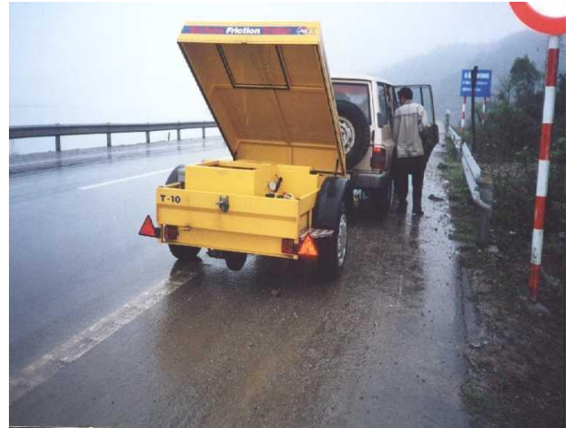
Hình 2. Xác định sức kháng trượt mặt đường bằng thiết bị SFT T10 trên QL1 đoạn Vinh - Đông Hà
