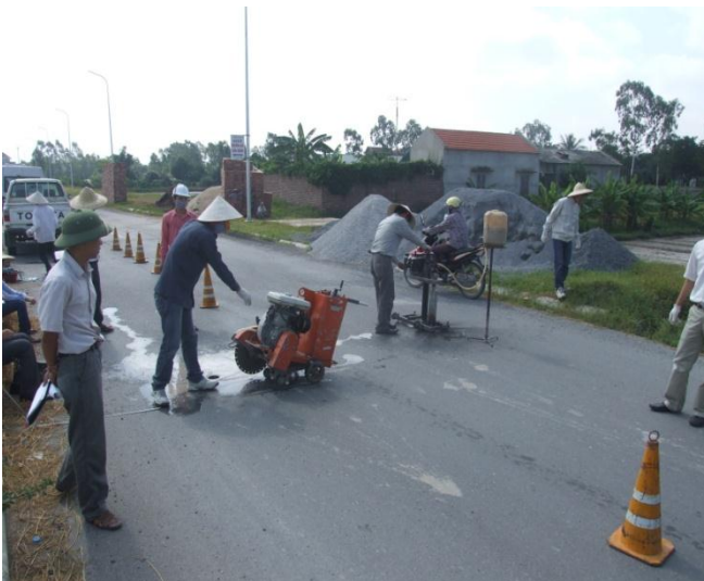
Hình 9. Kiểm định, xác định nguyên nhân hư hỏng mặt đường DĐT xây dựng đường vành đai TP. Phủ Lý.
